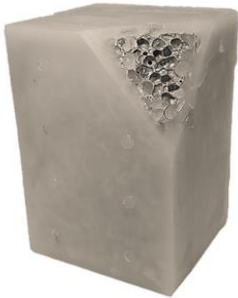
Abbildung 1: Hybridverbund bestehend aus einem mit thermoplastischem Kunststoff ummantelten Aluminiumschaum
